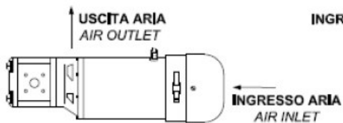
VE1 ■ VENTILAZIONE ESTERNA TIPO 1 TYPE 1 EXTERNAL VENTILATION
